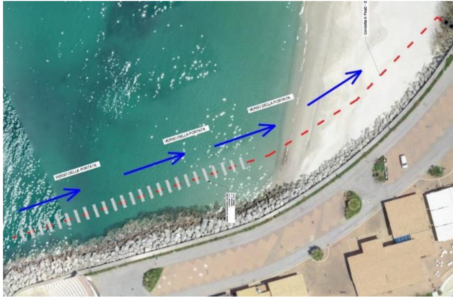
Figura 27: Planimetria della condotta di ricircolo di progetto
