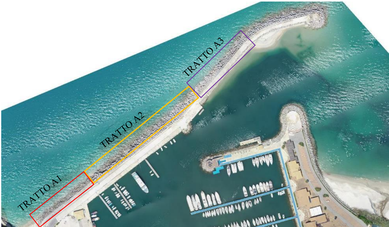
Figura 5: Suddivisione schematica del muro paronde
