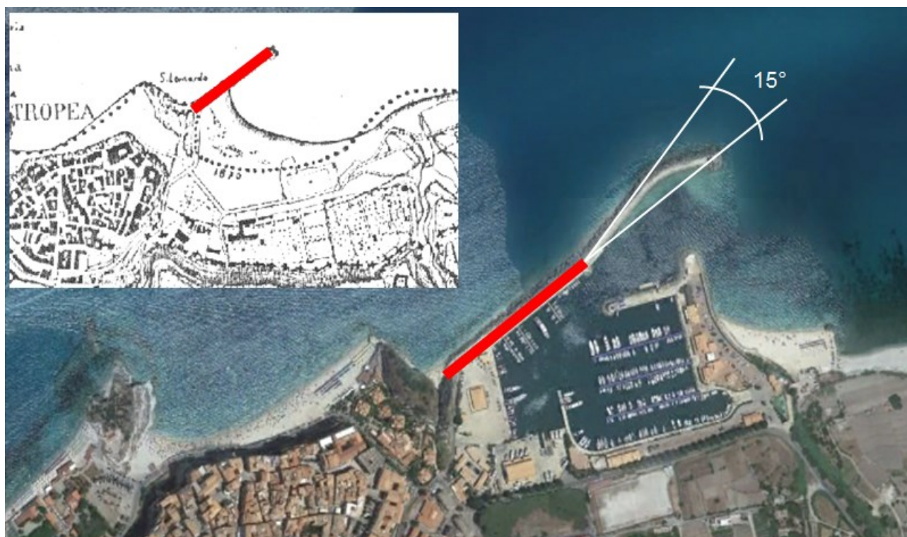
Figura 12 – Evidenziazione del punto angoloso lungo il paramento esterno del molo di sopraflutto, posto all'attacco tra il molo originario del 1947 ed il successivo prolungamento.
