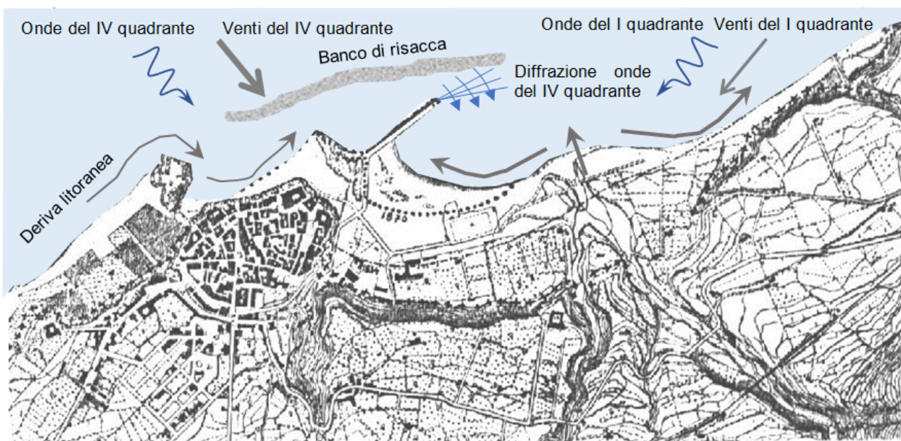
Figura 6 – Situazione nel 1947. La costruzione del molo non ha fatto che spostare il punto di diffrazione delle onde sulla testata dell'opera. Lo specchio acqueo in cui sorgerà il porto è ancora interessato da una deriva litoranea da Est a Ovest che accumula nella baia i sedimenti trasportati dal Lumia e dal delta del Torrente Grazie (che ha frattanto ricevuto come affluente il Torrente Burmaria).
