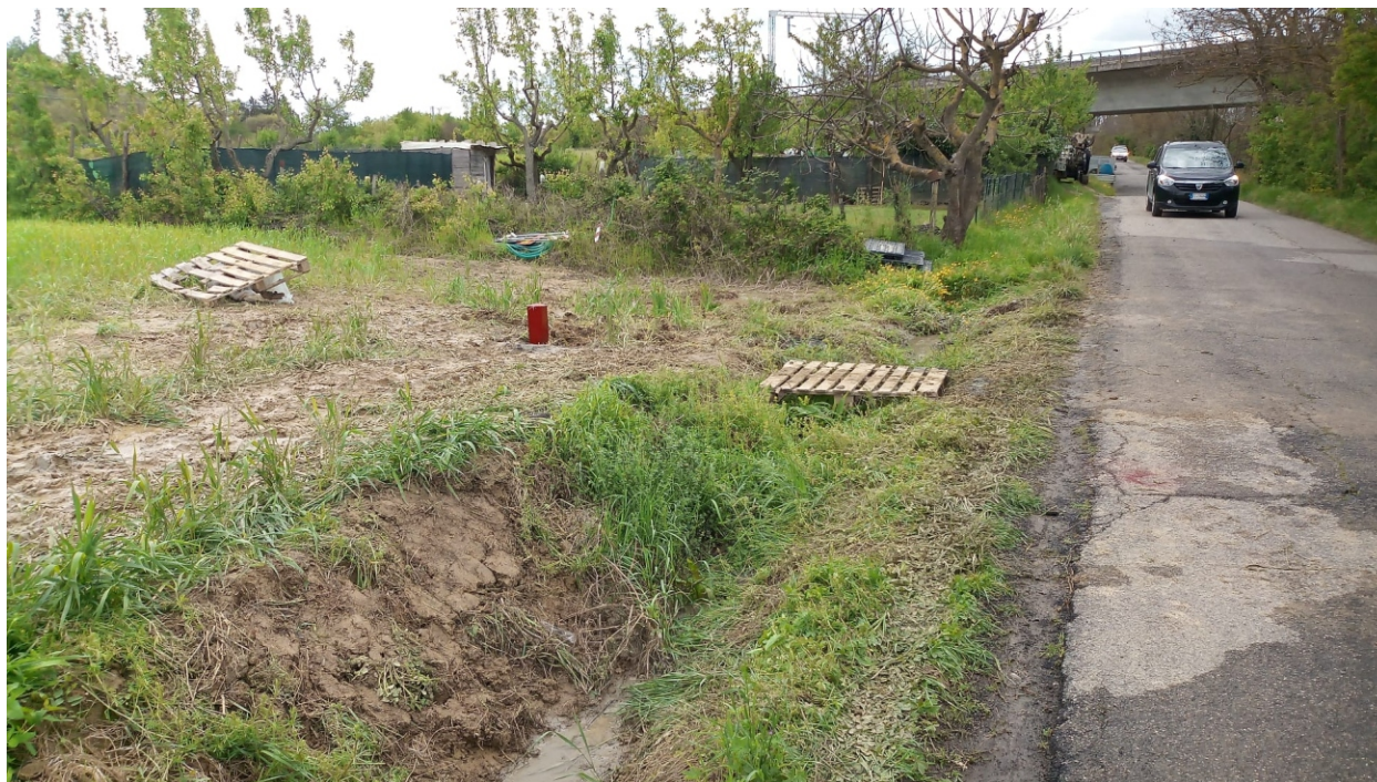
Pozzetto in ferro a protezione del Foro di Sondaggio C S04 attrezzato con tubatura in PVC per indagine geofisica di tipo Down-Hole
