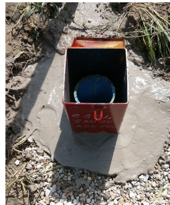
Pozzetto in ferro a protezione del Foro di Sondaggio C S04 attrezzato con tubatura in PVC per indagine geofisica di tipo Down-Hole
