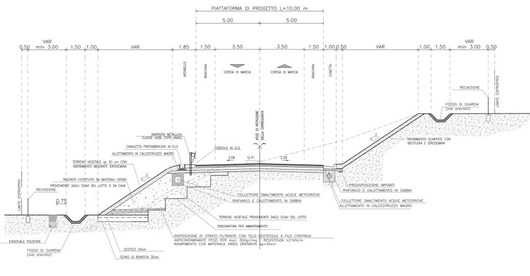
SEZIONE TIPO IN RILEVATO
