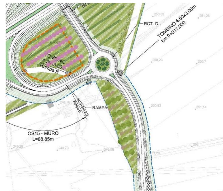
Figura 2.27 – Strada principale E78 e strada di collegamento E78 – S.R.71 in prossimità dello svincolo SAN ZENO in cui è evidente il progetto di mitigazione volto a lavorare in continuità con la matrice agraria del contesto
