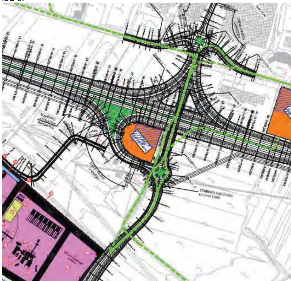
Figura 7-9 MICROFASE 2A - Realizzazione rotatoria tra S.S.73 e zona industriale San Zeno – CA06
