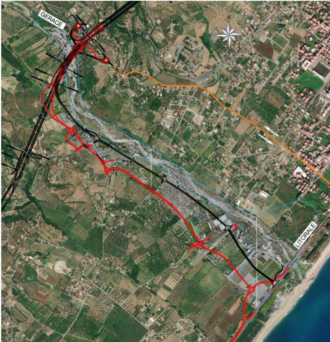
Lo spostamento della "bretella" è stato inoltre necessario al fine di ridurre quasi completamente l'interferenza del tracciato con la zona di vincolo paesaggistico della fiumara (Dlgs 42/2004 art. 142/c).
