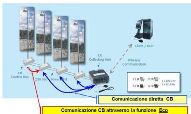
Figura 13- architettura sistema di gestione ad onde convogliate
