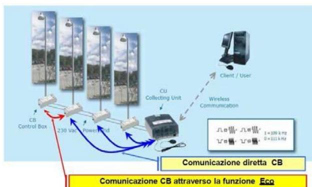
Figura 17- architettura sistema di gestione ad onde convogliate
