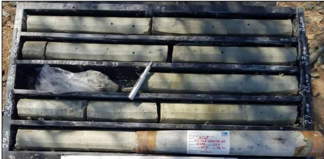
**Figura 7. Sondaggio SI 2 PZ. Formazione TRB da 25 a 30 metri**
