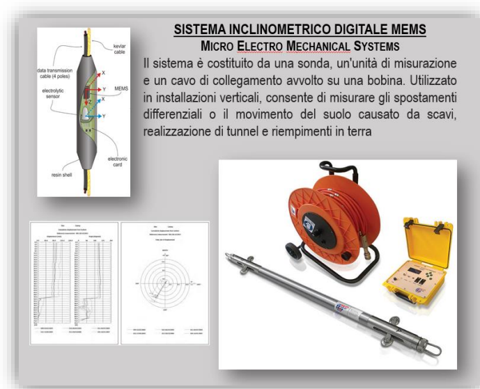
Figura 8. Strumenti di monitoraggio inclinometrico - MEMS
