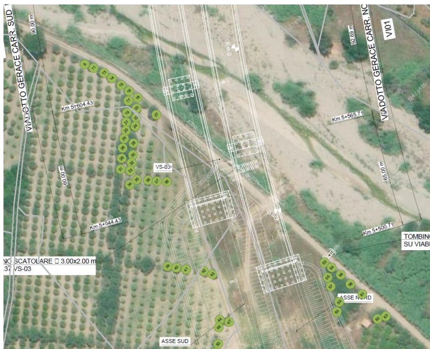
Figura 88 - Olivi interferiti presso Viadotto Gerace Cantiere operativo _01
