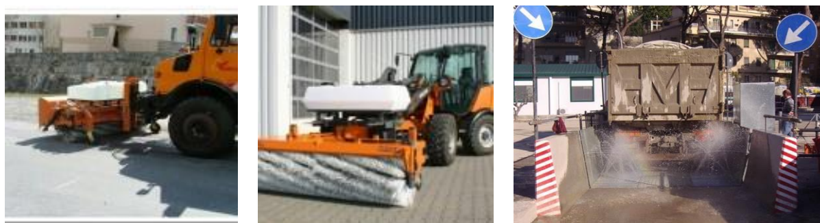
Figura 31 - Moto spazzole e vasche di lavaggio pneumatici
