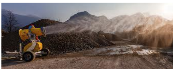
Figura 32 - Impianto di nebulizzazione
