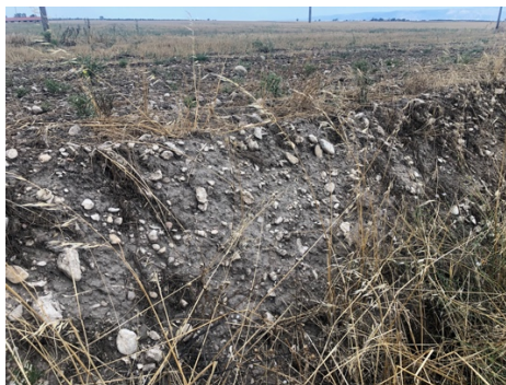
Affioramento dell'Unità litotecnica A nella zona del confine meridionale dell'area di intervento: terreno vegetale e materiali sabbioso-ciottolosi e limosi poco addensati, per uno spessore massimo compreso tra 2,0 e 3,0 m a partire dal piano campagna.
