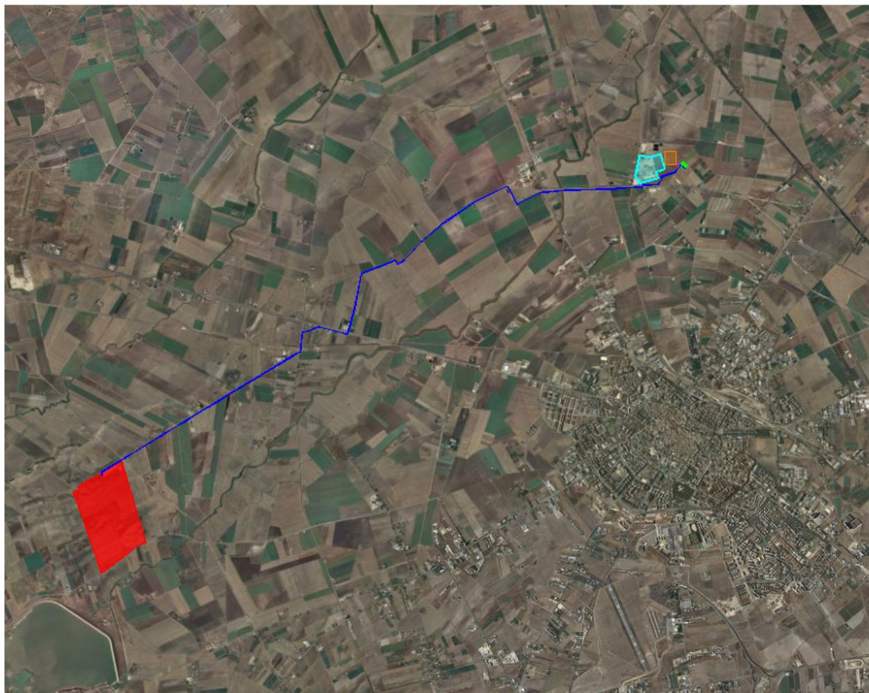
**Figura 3:** Inquadramento su ortofoto del cavidotto di vettoriamento (in blu nell'immagine su riportata)
