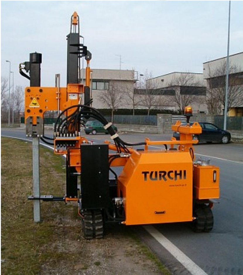
Figura 5: Esempio macchina battipalo.
