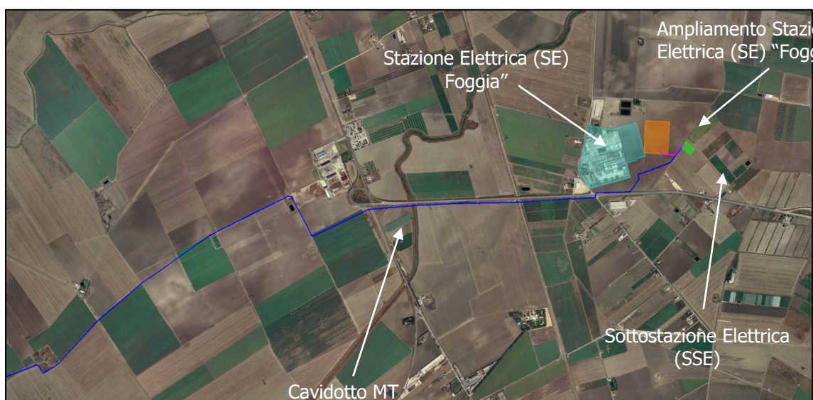
Figura 2: Inquadramento su ortofoto dell'area occupata dalla Sottostazione Elettrica AT/MT
