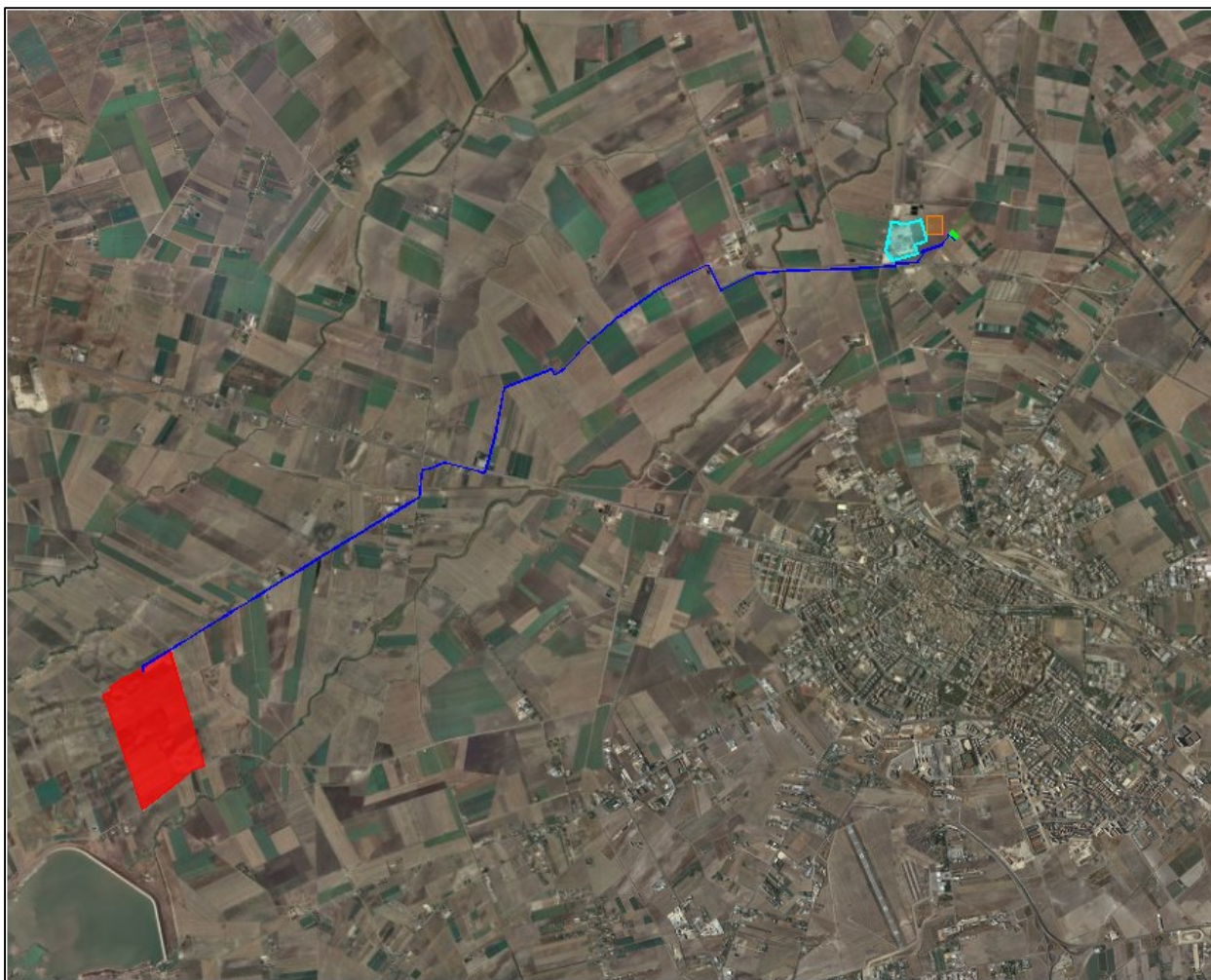
Figura 3: Inquadramento su ortofoto del cavidotto di vettoriamento (in blu nell'immagine su riportata)
