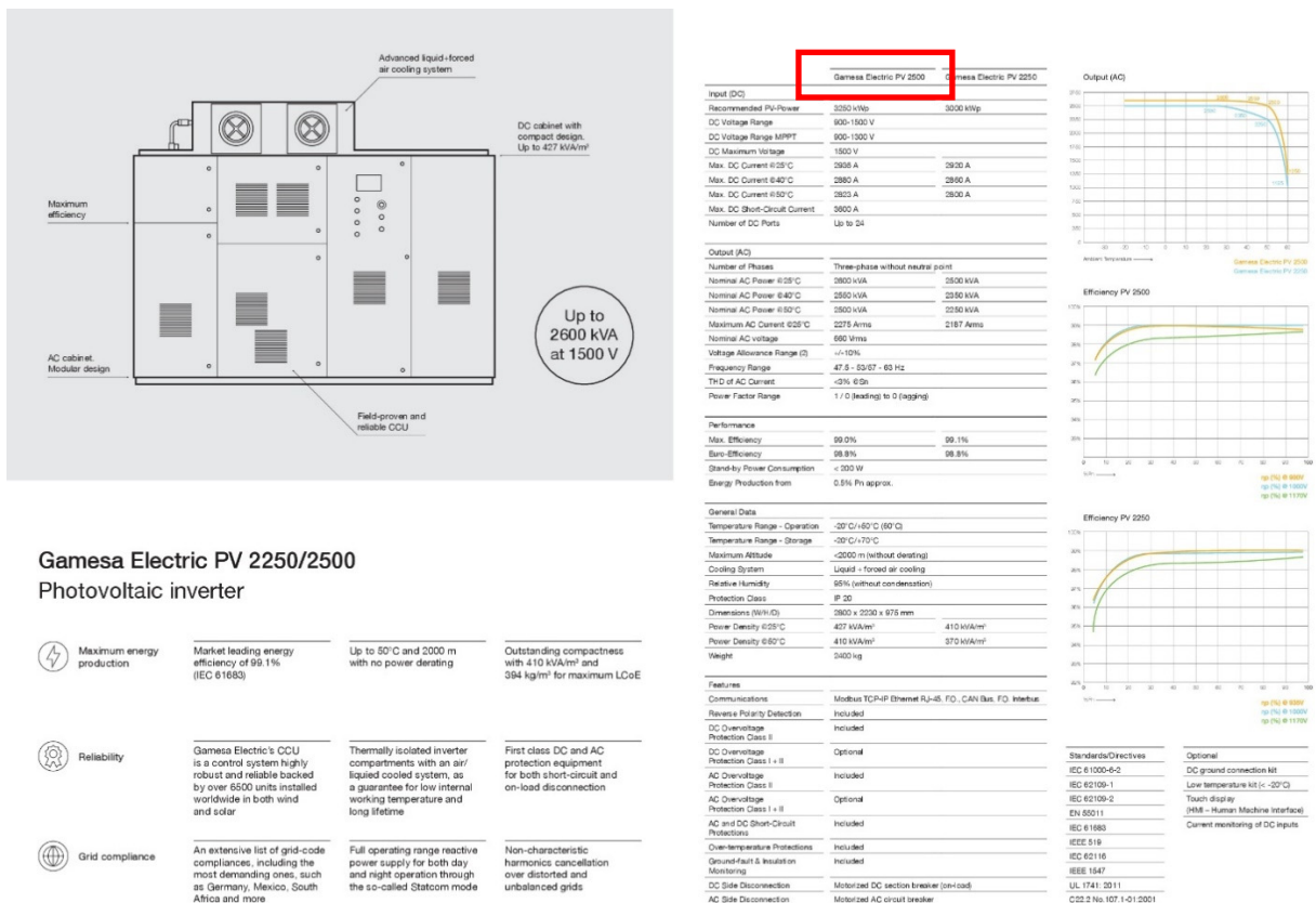
Figura 2: Scheda tecnica convertitore GAMESA 2500 kVA
