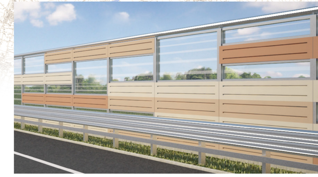
BARRIERA ACUSTICA MISTA FONOASSORBENTE-FONOISOLANTE
