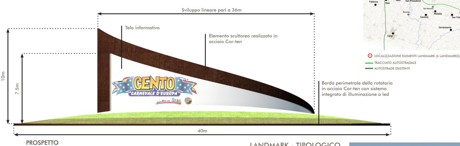
LANDMARK - TIPOLOGICO Planimetria, prospetto e simulazioni
