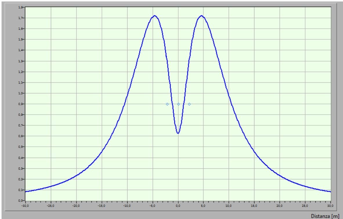
**Fig. 6 Profilo laterale campo elettrico (E) sbarre 150 kV**
