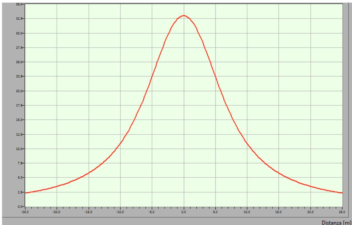
**Fig. 7 Profilo laterale induzione magnetica (B) sbarre 150 kV**
