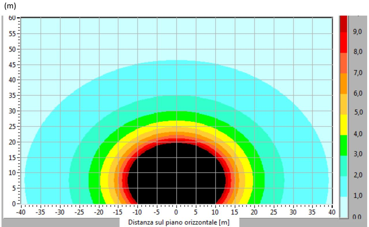
**Fig. 8 Mappa verticale induzione magnetica (B) sbarre 150 kV**
