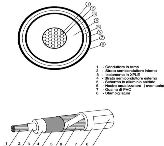
Figura 1. Schema tipo del cavo 150 kV
