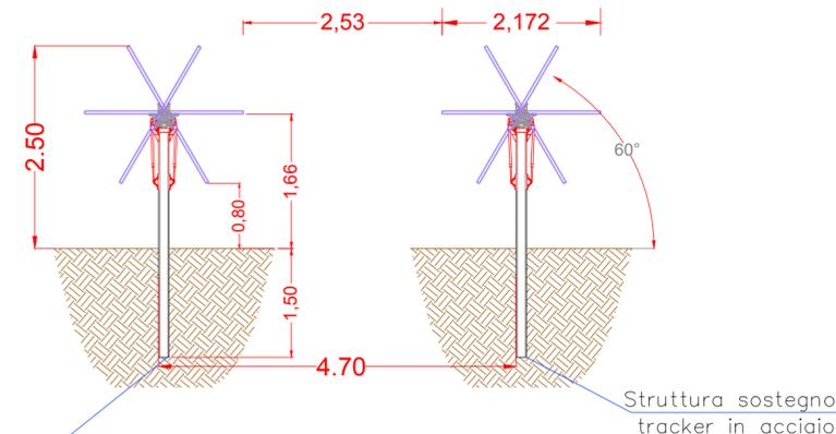
La profondità di interrimento della struttura deve essere decisa dal fornitore del sistema tracker in base all'analisi del terreno, ma deve essere  $\geq 1m$ .
