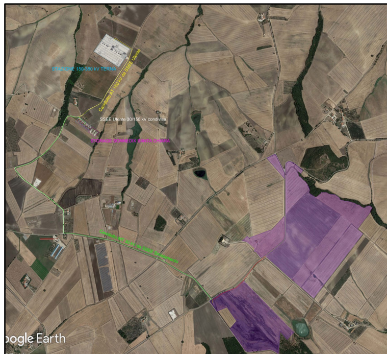
Fig.1-4. Layout impianto e cavidotto su ortofoto (GoogleEarth®).
