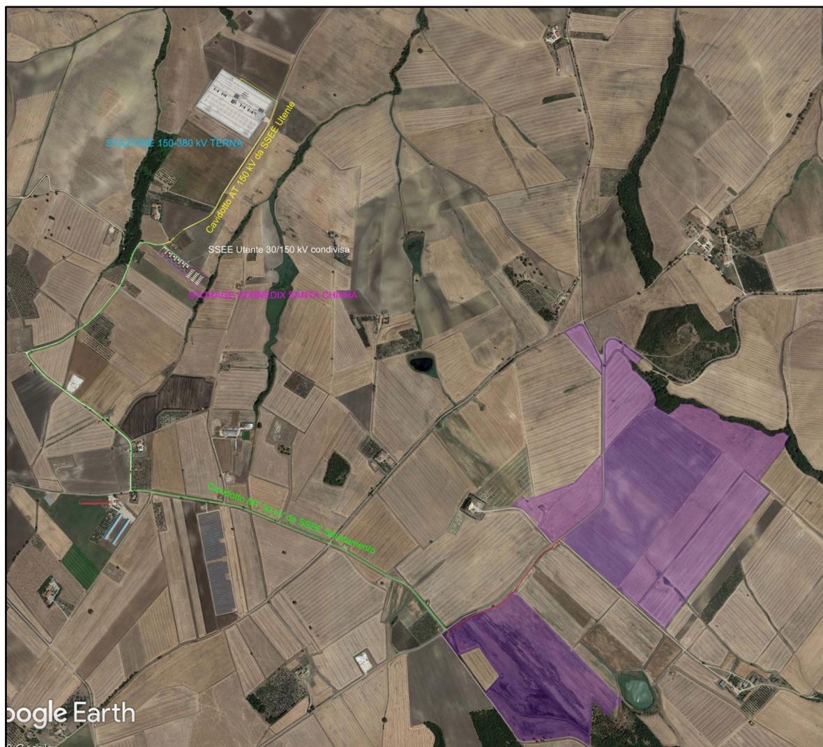
Fig.1-4. Layout impianto e cavidotto su ortofoto (GoogleEarth®).
