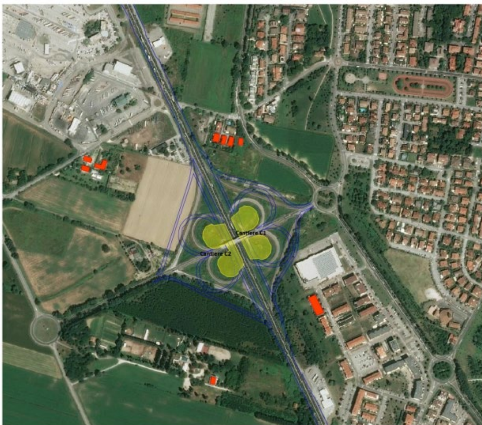
Figura 8 – Ricettori più prossimi alle aree di cantiere (con posizionamento peggiore delle macchine assunte in sede di PD)
