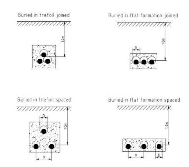
I cavi verranno posati con una protezione meccanica (lastra o tegolo) ed un nastro segnalatore ad una distanza non inferiore a 20 cm dalla protezione meccanica o dal cavidotto. Su terreni pubblici e su strade pubbliche la profondità di posa dovrà essere comunque non inferiore a 1,2 m previa autorizzazione della Provincia. I cavi verranno posati in una trincea scavata a sezione obbligata.
