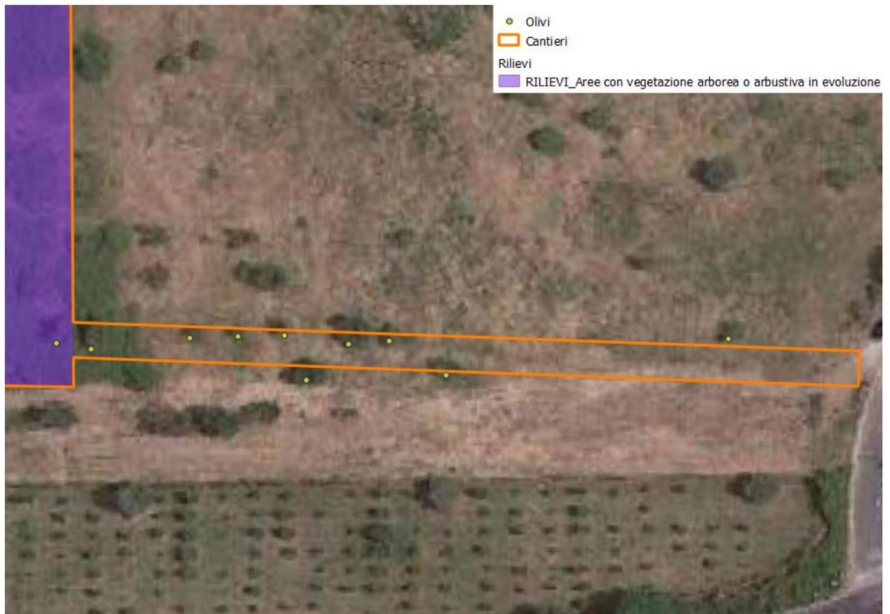
*Figura 6-20: Pista di cantiere relativa all'area del PZ1 con individuati gli olivi da espantare e ritrapiantare*
