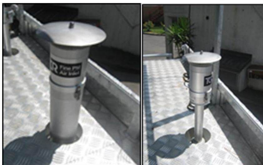
Figura 2-116 Teste di prelievo PM10 e PM2,5
