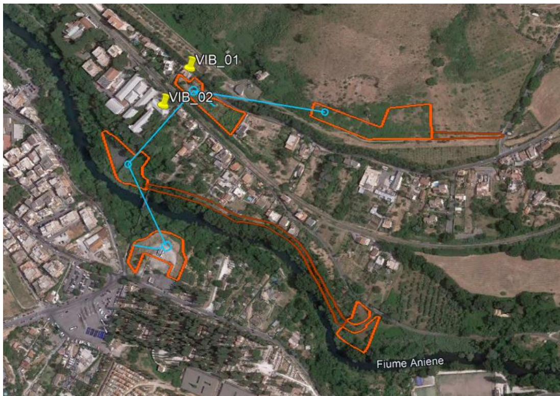
Figura 8-9 localizzazione punti di monitoraggio per le vibrazioni
