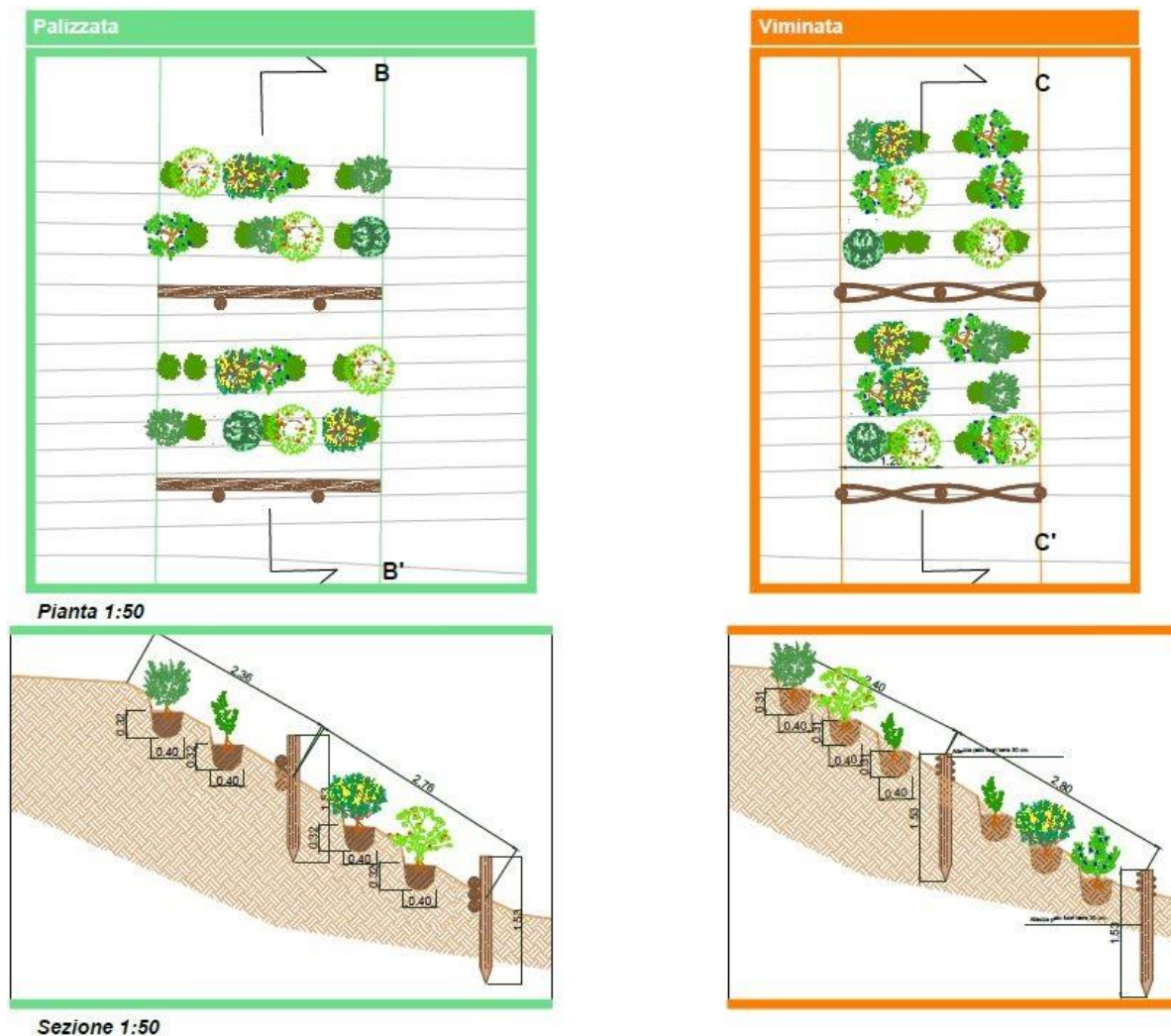
Figura 5-3 Tipologici d'impianto per gli interventi di ingegneria naturalistica denominati Palizzata (in verde) e viminata (in arancione).
