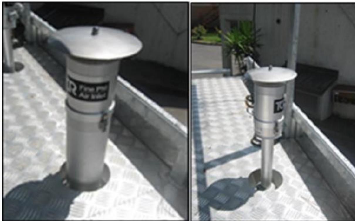
Figura 2-24 – Teste di prelievo PM10 e PM2,5.
