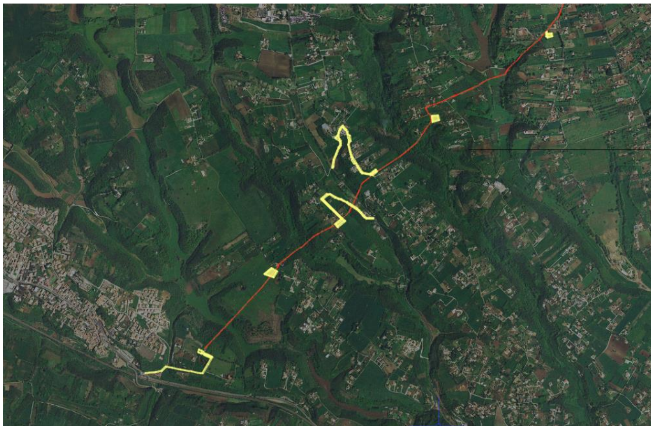
Figura 3-12: Tratto C, porzione sud cantieri e accessi (giallo) tracciato in progetto (rosso)
