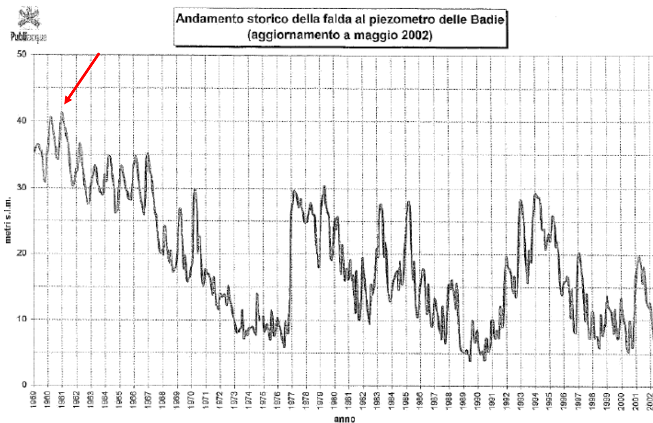
Fig. 6.7. Letture piezometriche Badie 1959-2002 (dati Publiacqua). La freccia indica la quota della piezometrica in prossimità del piano campagna.
