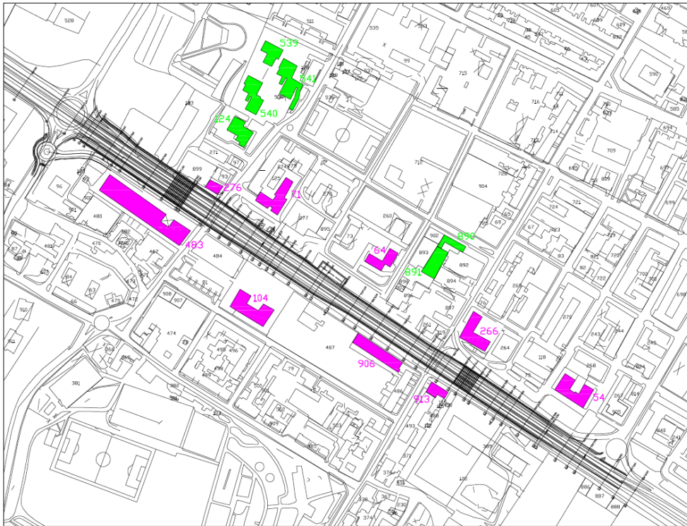
Stralcio cartografico con identificazione degli edifici per i quali sono state effettuate le valutazioni integrative delle concentrazioni di PM10 (in verde i ricettori sensibili)
