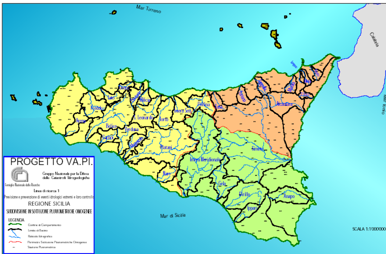
FIGURA 5.2.1- SUDDIVISIONE IN SOTTOZONA PLUVIOMETRICHE OMOGENEE: A (GIALLO), B (ARANCIO), C (VERDE).
