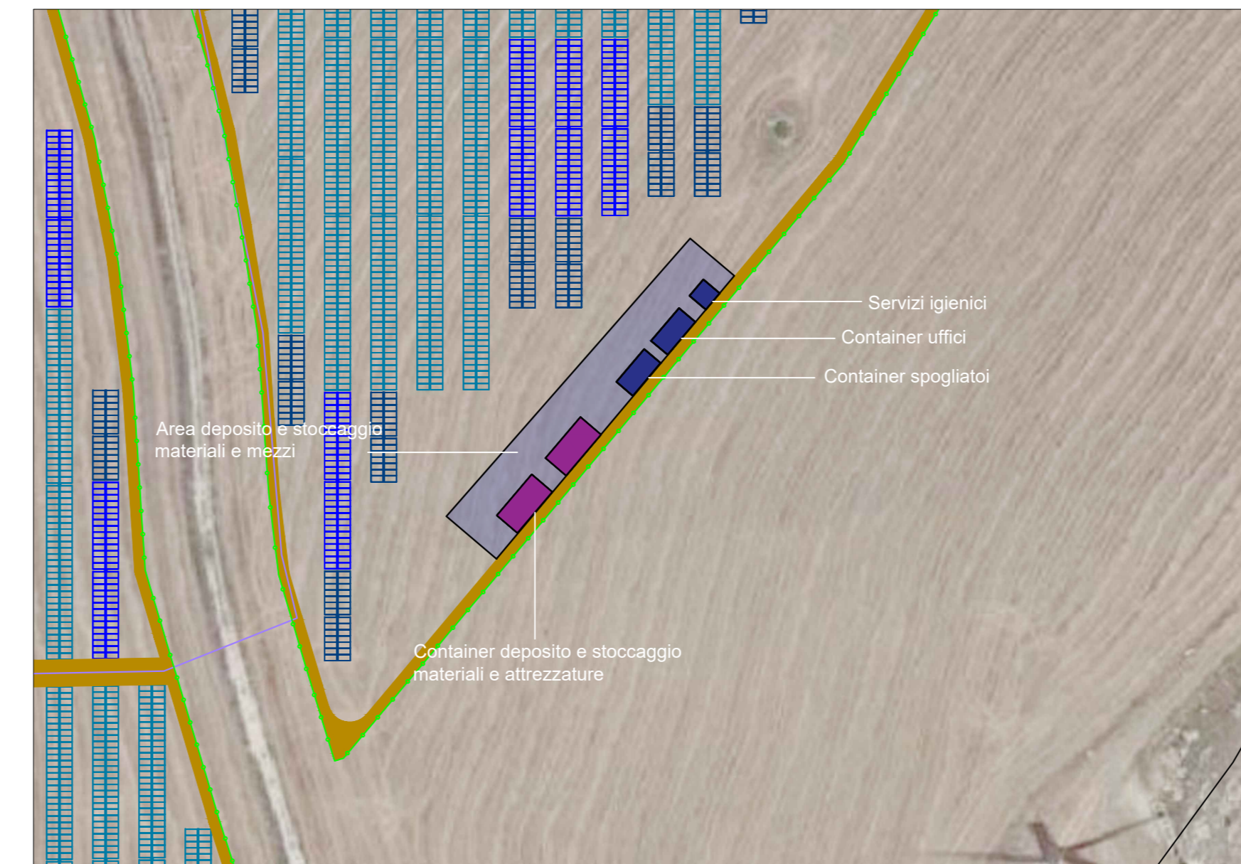
Particolare 2 aree cantiere - Scala 1:1000
