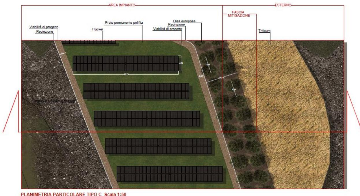
FIGURA 45 – PARTICOLARE TIPO C: FASCIA DI MITIGAZIONE PERIMETRALE E AREA DESTINATA A GRANO (ESTRATTO DA MINEO-PDT11)
