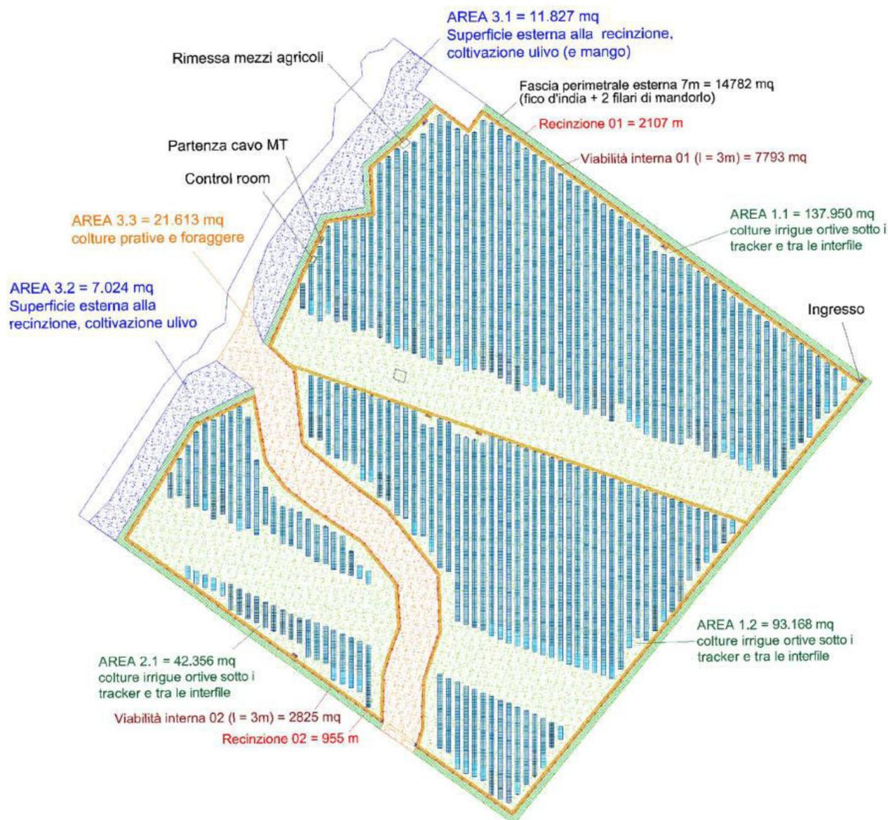
Figura 6.6. – Layout dell'impianto agrovoltaico con indicazione delle aree agronomiche.
