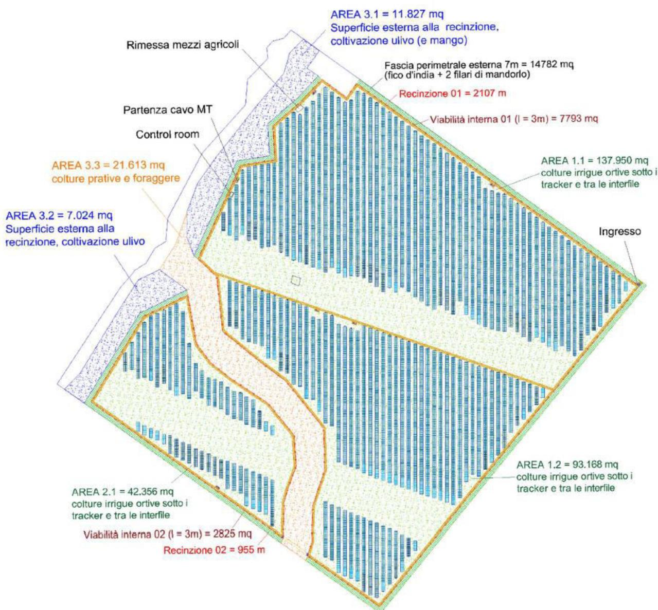
Figure 11.1. – Impianto agrovoltaico con indicazione delle aree coltivabili.
