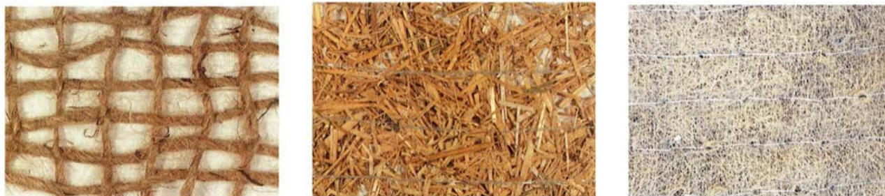
Figura 36 - Esempi di materiali di rivestimento biodegradabili: a sinistra georete in fibra di juta, al centro biostuoia in paglia ricoperta con materiale plastico fotodegradabile, a destra biostuoia in fibra di cocco ricoperta con materiale plastico fotodegradabile (da REGIONE LIGURIA, 1997).
