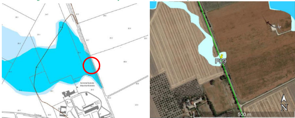
Figura 5.25: A sinistra stralcio del PGRA con in rosso l'area di interferenza. A destra stralcio del PAI con relative fasce di pericolosità idraulica e in verde la linea di connessione.
