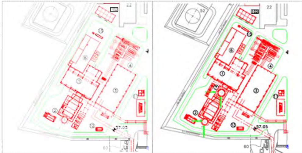
Figura 4. Confronto layout isola di potenza senza e con camino di by-pass (in pianta)
