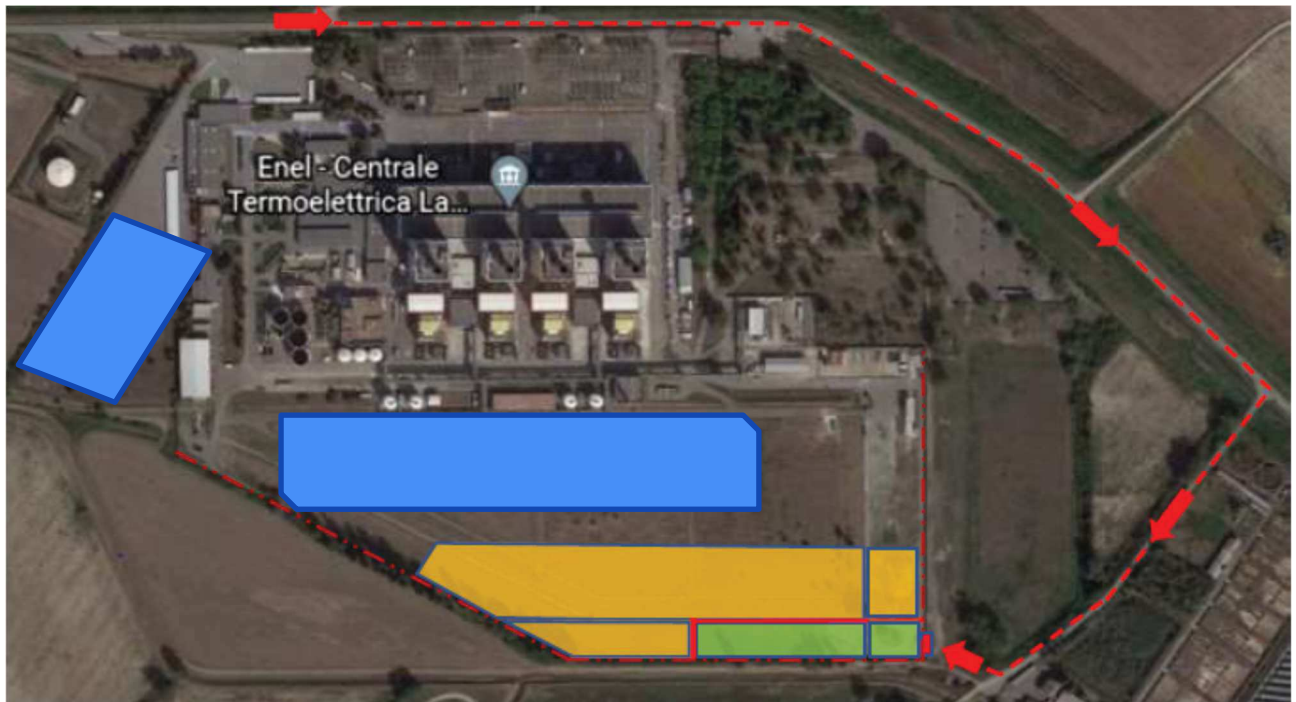
Figura 2.2.1.1 – Rappresentazione di: aree dei lavori per la nuova unità a gas in blu (area CCTG e area sistemi ausiliari), in giallo e verde : aree logistiche cantiere CCTG,
