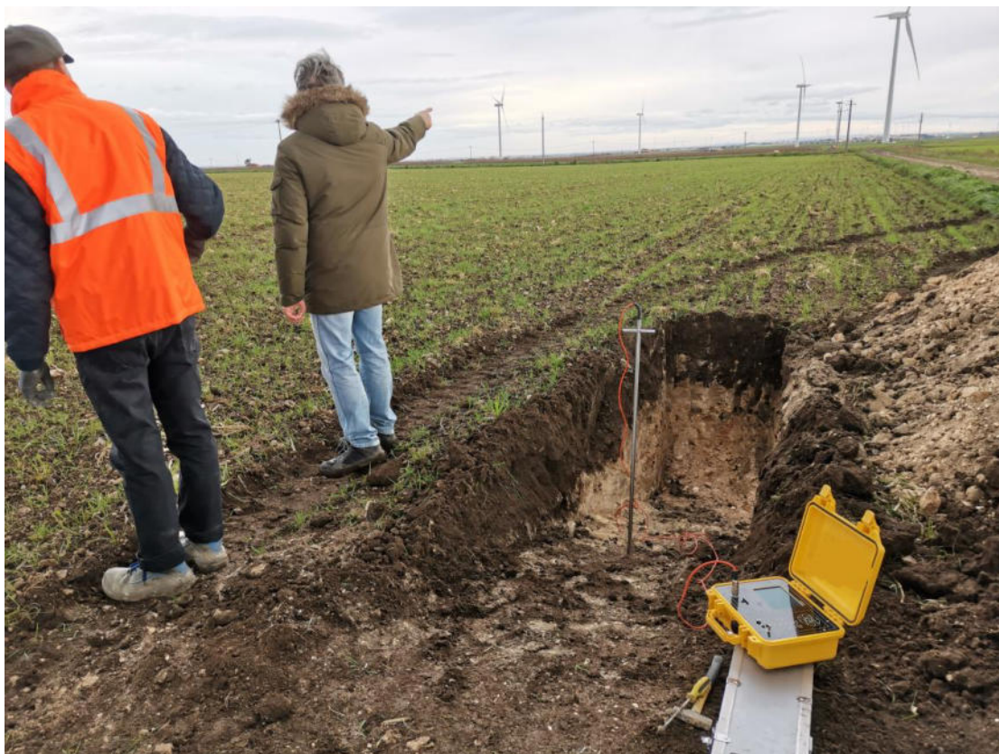
FOTO 3 – MISURE DI RESISTIVITÀ TERMICA TRINCEA 3
