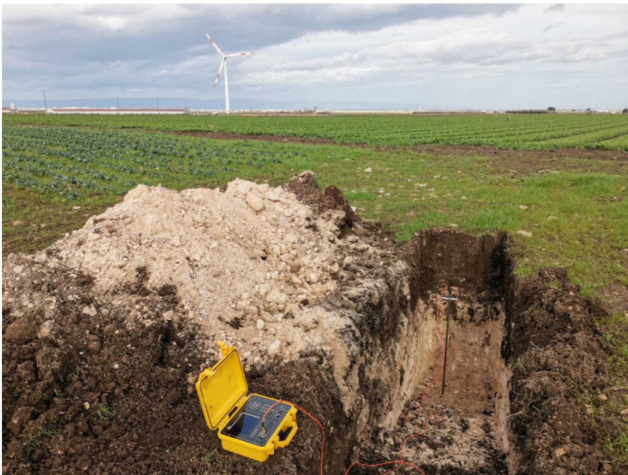
FOTO 7 – MISURE DI RESISTIVITÀ TERMICA TRINCEA 7
