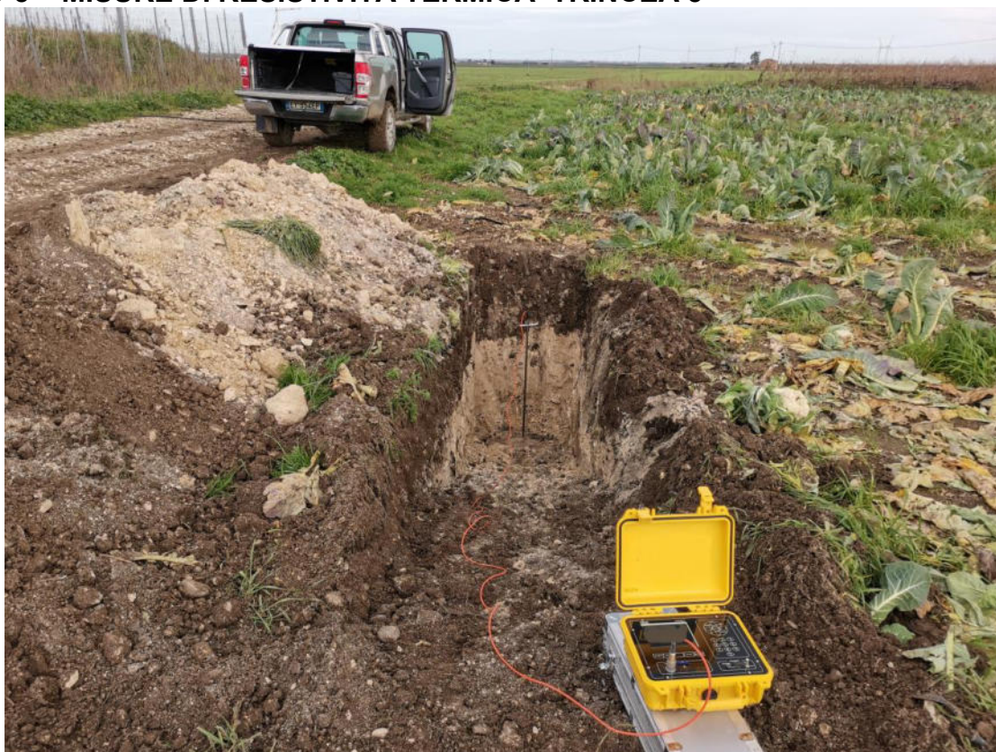
FOTO 6 – MISURE DI RESISTIVITÀ TERMICA TRINCEA 6
