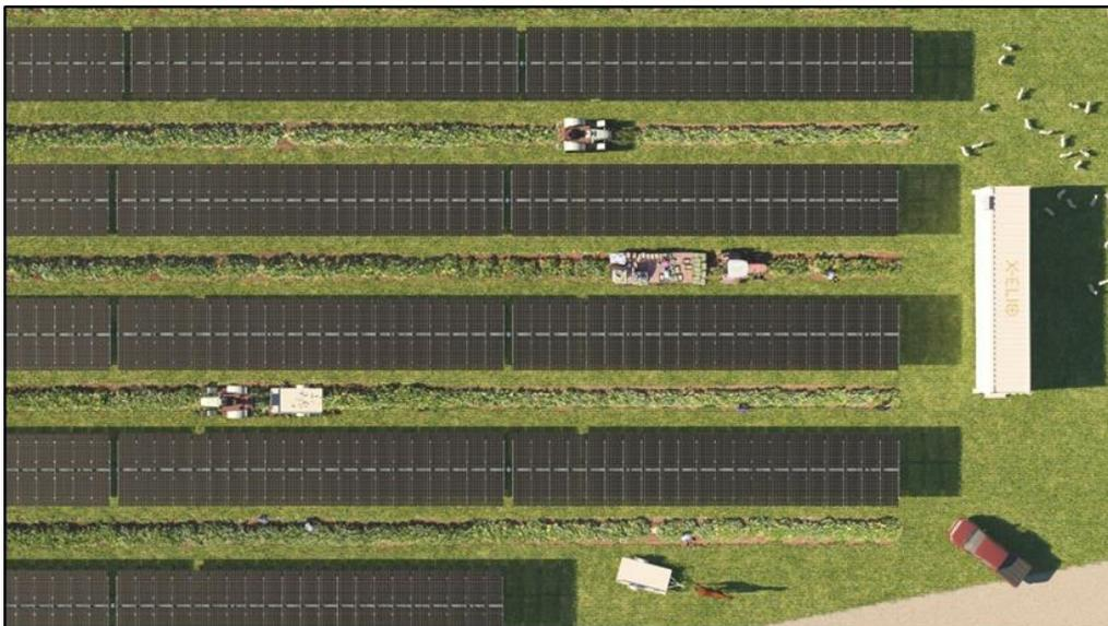
**Dettaglio planimetrico delle aree lasciate libere alla coltivazione in filari mentre sotto ai pannelli le colture a favino (sovescio) alternate da naturale inerbimento.**
