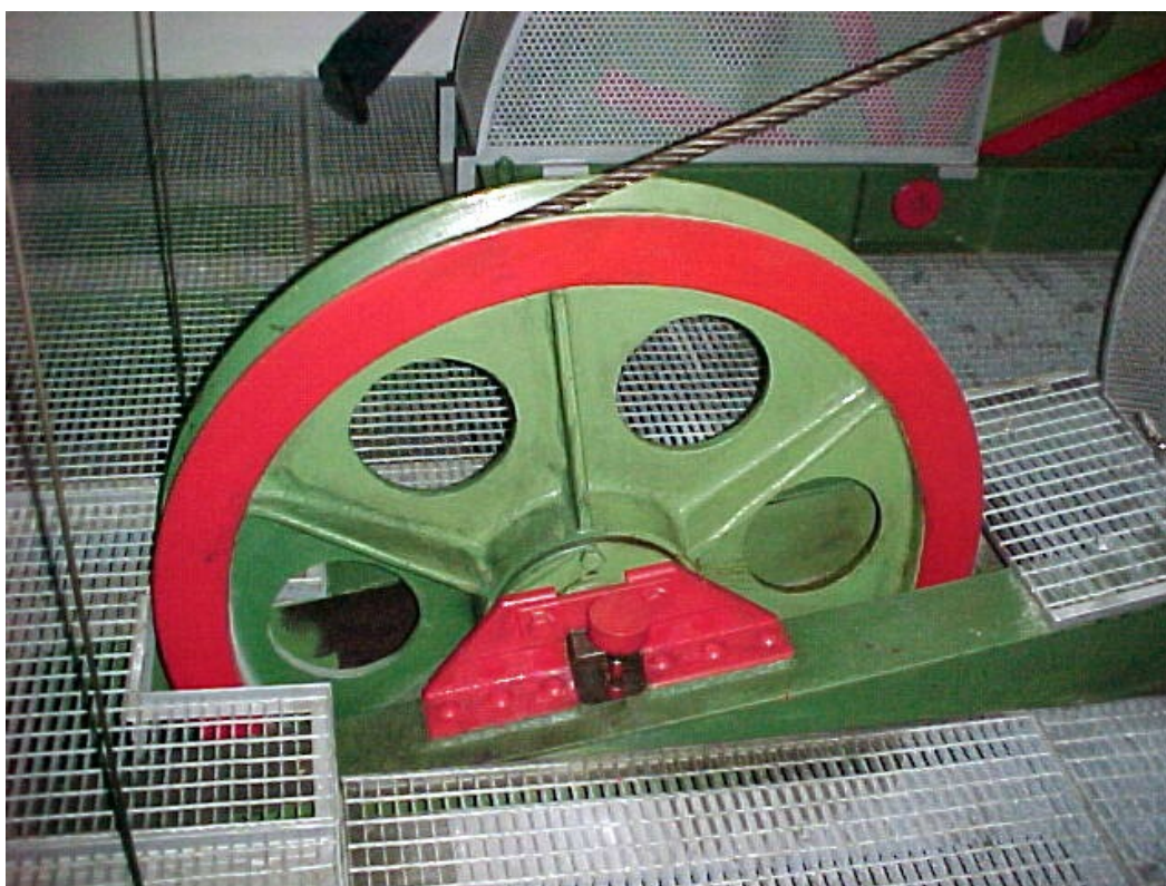
Figura 8.2: puleggia di deviazione dell'anello trattivo
