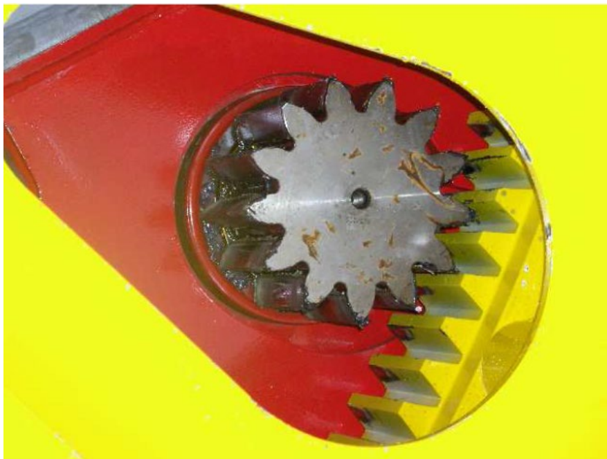
Figura 8.8: accoppiamento pignone-corona (organo di recupero)
