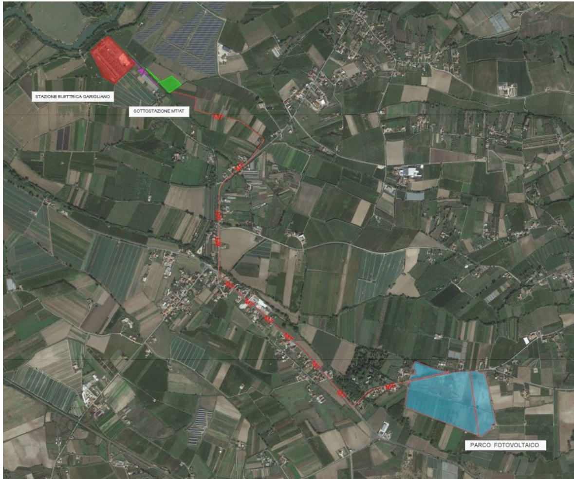
Ortofoto con indicazione del Parco Fotovoltaico e del cavidotto di connessione alla Sottostazione Elettrica d'Utenza (SSE) di proprietà del Produttore
