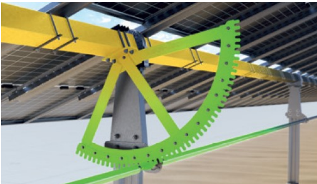
Dettaglio movimentazione con inseguitore monoassiale Est-Ovest
