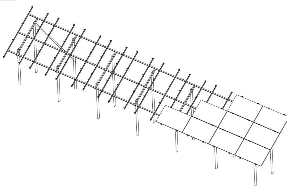
**Figura 12** - Schema strutture di sostegno
