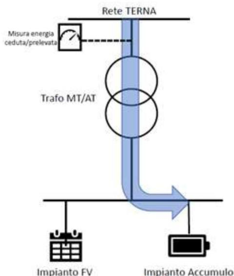
In questa modalità di esercizio, la batteria, indipendentemente dalla modalità di esercizio dell'impianto fotovoltaico, assorbe ed immette, in orari differenti, potenza dalla rete per fornire servizi di rete **volti alla stabilità e bilanciamento della rete stessa, quali riserva primaria, secondaria e terziaria.**
