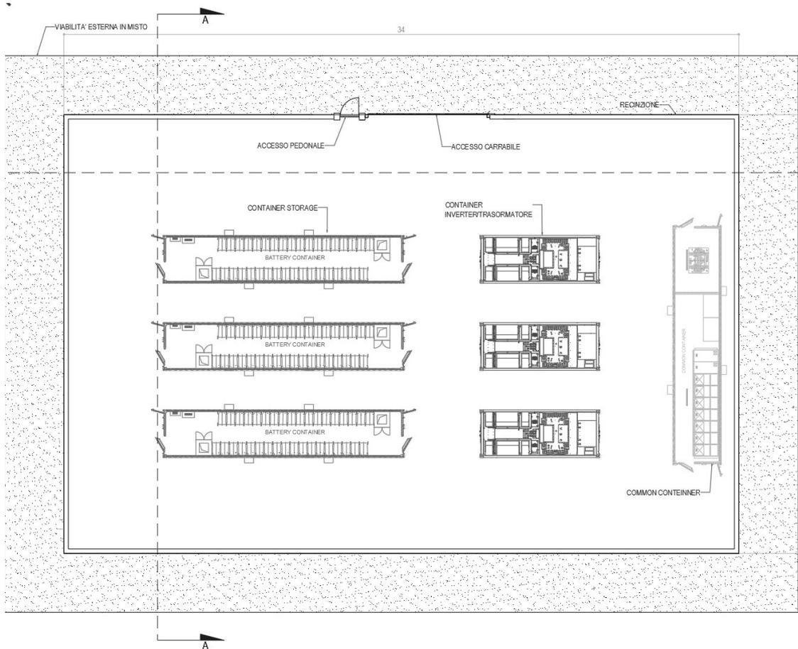
Figura 28 - Planimetria impianto di accumulo elettrochimico
