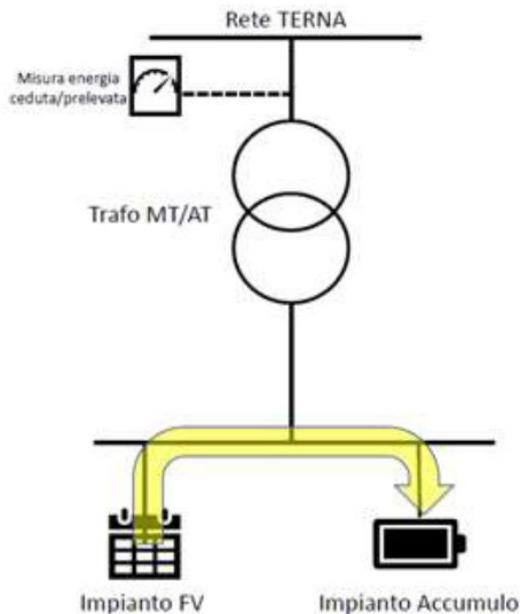
In questa modalità di esercizio, l'impianto fotovoltaico non cede l'energia prodotta da fonte solare direttamente alla rete ma la stessa viene immagazzinata nel sistema di accumulo per essere successivamente rilasciata
