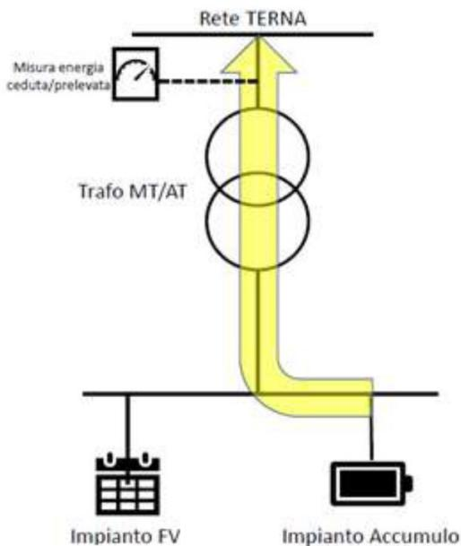
In questa modalità di esercizio, la batteria rilascia anche in orari differenti da quelli diurni, l'energia precedentemente immagazzinata dall'impianto fotovoltaico
