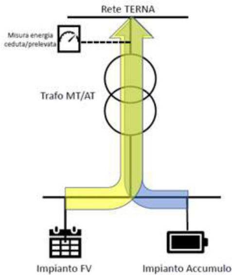
In questa modalità di esercizio, la batteria rilascia energia alla rete per fornire i servizi di rete (vedi modalità di funzionamento E) e l'impianto FV produce energia. La potenza totale immessa in rete, in ipotesi può essere la somma delle potenze massime dei due impianti.
