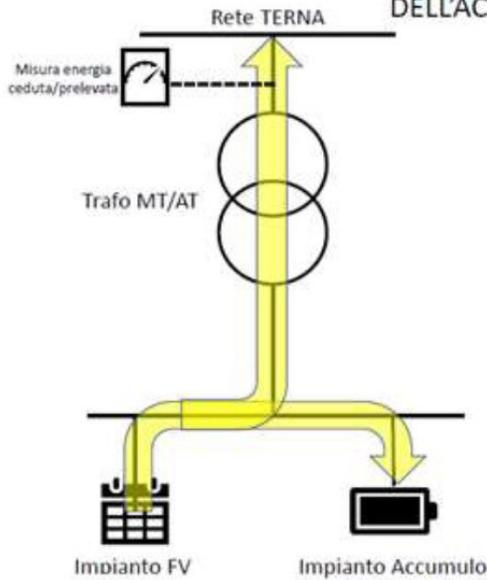
In questa modalità di esercizio, l'impianto fotovoltaico cede parte dell'energia prodotta da fonte solare direttamente alla rete e parte viene destinata alla ricarica del sistema di accumulo, per essere successivamente rilasciata
