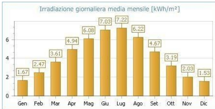
FIG. 6.2 - IRRADIAZIONE GIORNALIERA MEDIA MENSILE SUL PIANO ORIZZONTALE [kWh/m 2 ]- FONTE DATI: UNI 10349 - LOCALITÀ DI RIFERIMENTO: POTENZA (PZ)/MATERA (MT)
