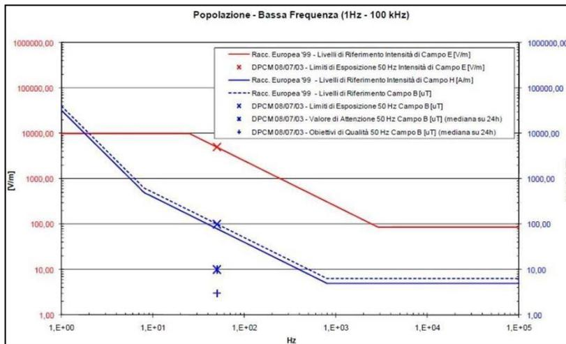
Figura 13.7. – Livelli esposizione Bassa Frequenza (1Hz – 100 kHz).
