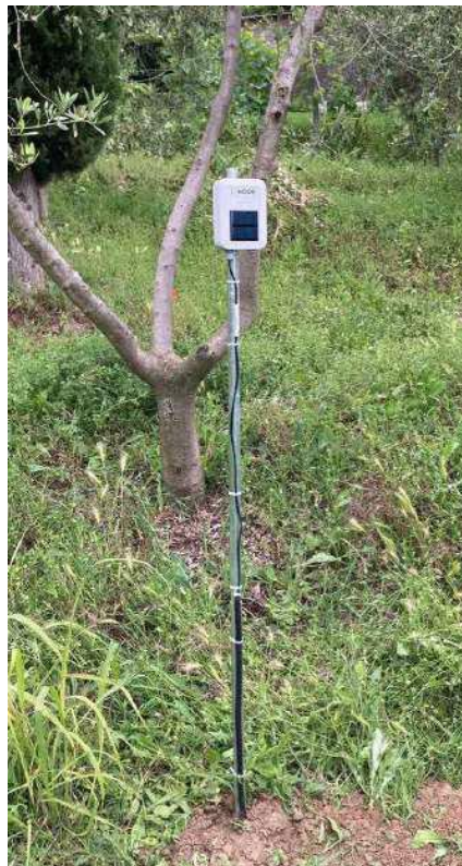
Esempio di installazione di sensore per il rilievo temperatura e umidità del suolo
